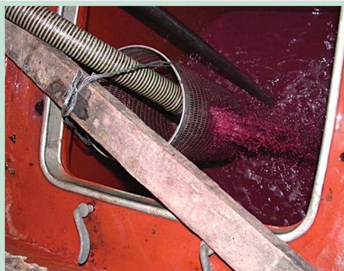
Abb. 68: Abbildung einer Über-Pump-Vorrichtung (remontages) mit Lüftung.
