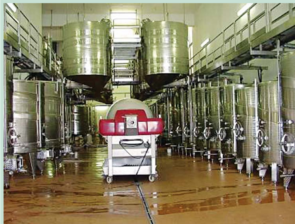
Abb. 62: Rotwein Fermentationstanks oberhalb, um die waagerechte Tankpresse ohne Pumpvorgang zu befüllen.
