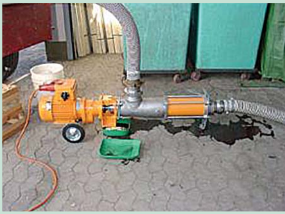
Abb. 63: Maischepumpe, um die fermentierte Maische zur Presse zu transportieren.
