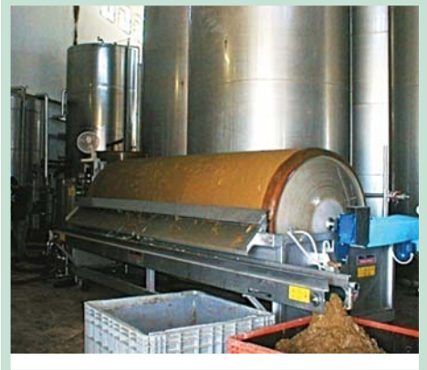
Abb. 45: Hefe-Most-Pressfilter und rotierender Vakkumfilter mit Zellulose, Kieselerde oder Perlit
