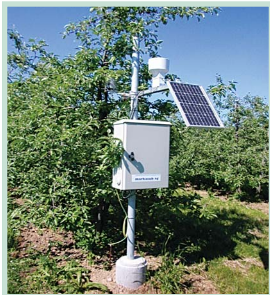
Abb. 20: Eine "LUFFT" Wetterstation, die verwendet werden kann, um den Befallsdruck von Pilzen Krankheiten im Model darzustellen. 4
