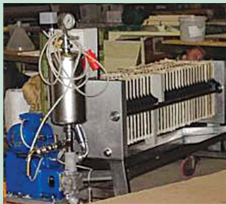
Abb. 45: Hefe-Most-Pressfilter und rotierender Vakkumfilter mit Zellulose, Kieselerde oder Perlit
