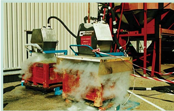
Abb. 64: Technische Ausrüstung für die Kaltmazeration mit Trockeneis. Produktion von Kohlensäureschnee
