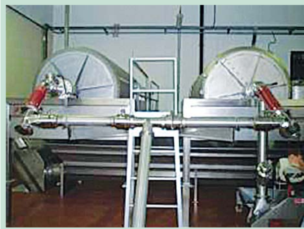
Abb 69: Rotwein-Mazerationstank: Rotationstanks, Hydraulischer-Tauchfermenter aus rostfreiem Edelstahl
