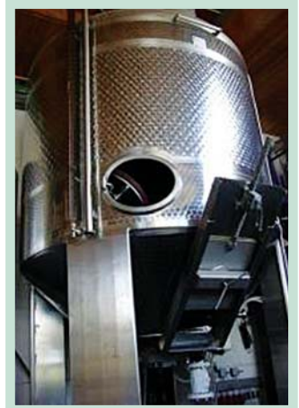
Abb 69: Rotwein-Mazerationstank: Rotationstanks, Hydraulischer-Tauchfermenter aus rostfreiem Edelstahl
